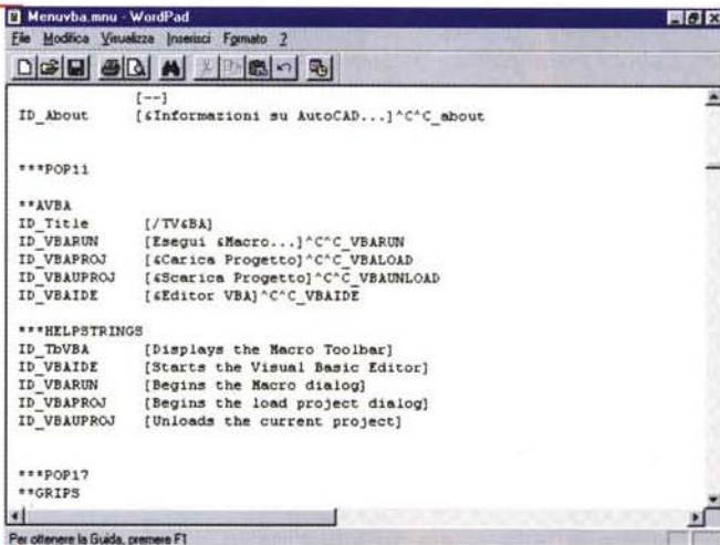
Figura 1 - AutoCAD 14 - Costruzione del ramo di menu VBA al quale agganciare i nostri esercizi. Il menu di AutoCAD è facilmente personalizzabile. Basta editare direttamente il file Menu.mnu, oppure editarne un duplicato, ad esempio Menuvba.mnu. In tale file si aggiunge una sezione, magari copiandola da una già esistente, la cui voce principale sia VBA e le cui voci secondarie siano Carica, per caricare il programma VBA, ed Esegui, per eseguirlo, a queste voci vanno associati i comandi che debbono essere eseguiti (li potete leggere nel listato). Una volta salvato il file con il menu lo si può caricare digitando, nella riga dei comandi di AutoCAD, il comando Menu, che attiva la finestra File Apri, nella quale si cerca il file con desinenza mnu.
